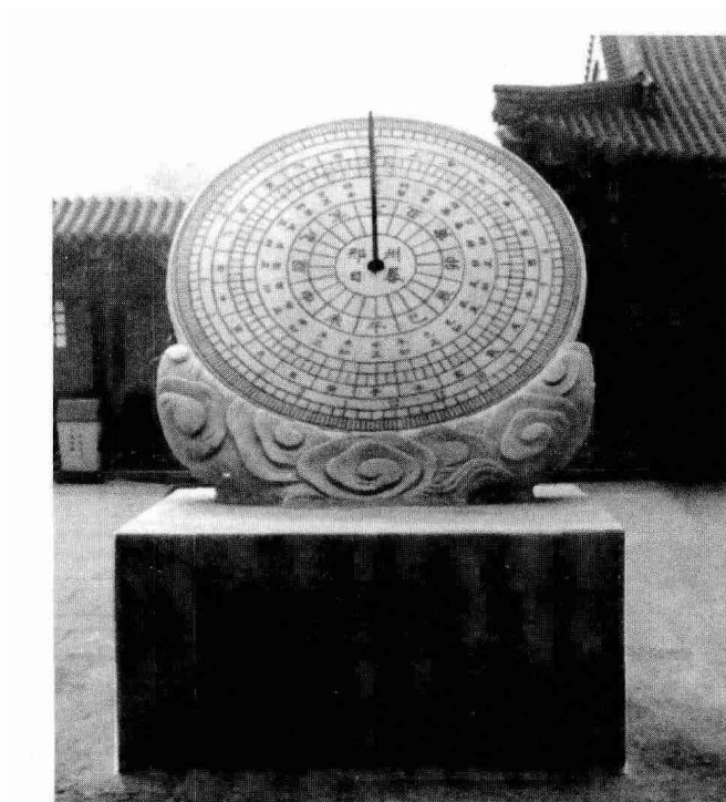
图6 邢台郭守敬纪念馆的赤道式日晷,一个时间差改正为 \Delta t = 22 分钟 (最外圈的时间刻线向逆时针方向转动了 5^{\circ}30' ) 的“经度差改正-换算型日晷”
